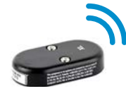
IR/RF-Gerätesender an Betten und anderen mobilen Geräten
